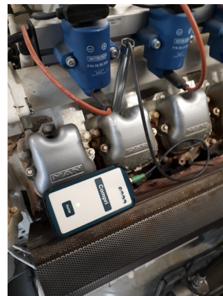
Compri Gerät installiert auf einem kraftwerk MAN E2842 Le312 gasmotor
